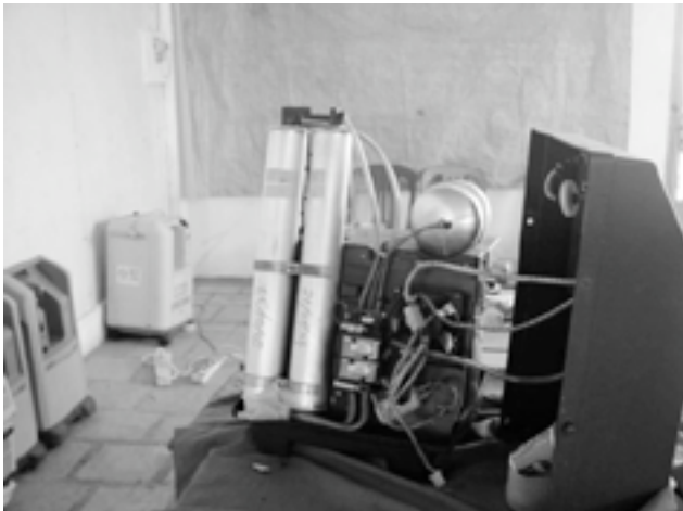
Figure 4 - Concentrateur d'oxygène démonté : le compresseur et les 2 colonnes de Zéolithe
