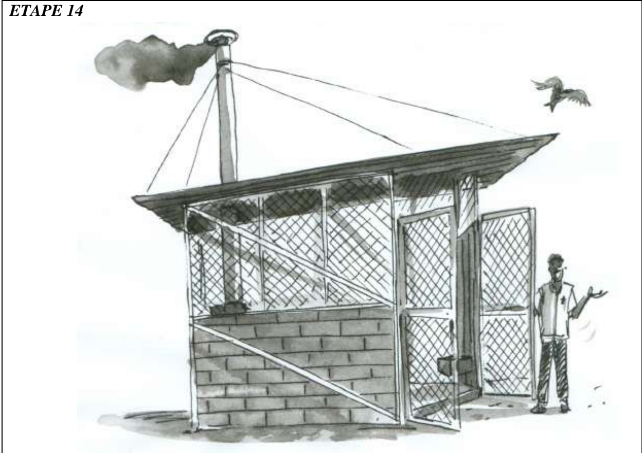
Illustration 2.3.14 UTD terminée, équipée d'une clôture en grillage d'acier, le spigot et la porte de cendre sont montés.
