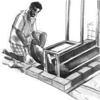
Illustration 2.3.5 Placer la charpente métallique et le coulis de ciment sur la Dalle PCC
