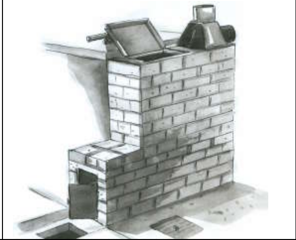
Illustration 2.3.10 Maçonnerie de l'incinérateur terminée avec porte de chargement
