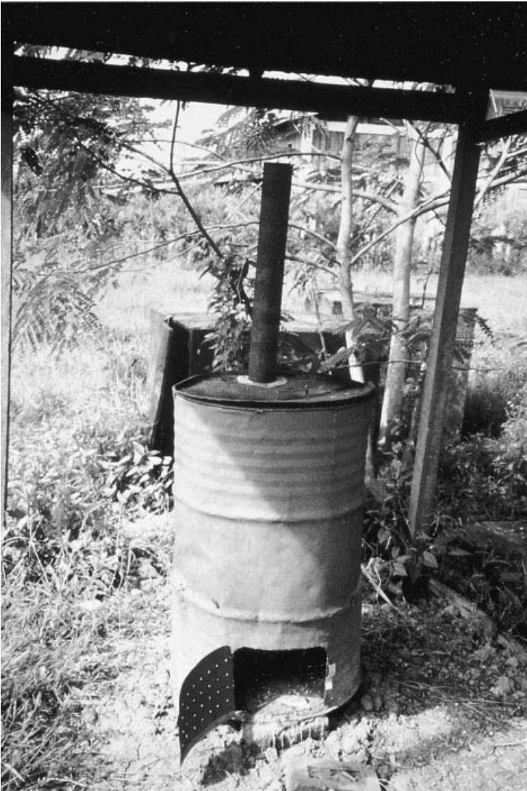
Figure 4.3 : Incinérateur dans un bidon métallique avec cheminée
