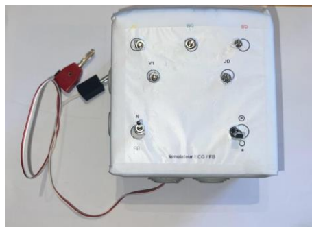
Figure 9 : Simulateur low-tech d'ECG Fibrillation / Normal
