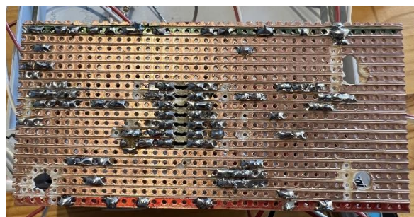
Figure 5 : Schéma de la face des composants et de la face métallique de la plaque à trous
