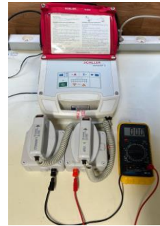
Figure 9 : Palettes de défibrillation placées sur le testeur low-tech
