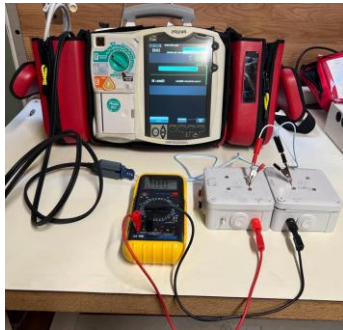
Figure 8 : Électrodes de défibrillation branchées au testeur low-tech
