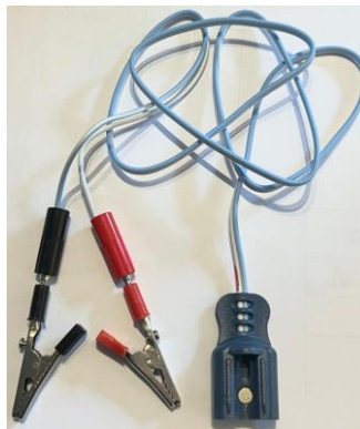
Figure 6 : Electrode de défibrillation adaptée au testeur low-tech de défibrillateur
